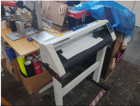
SCHNEIDEPLOTTER GRAPHTEC CE 5000-60
